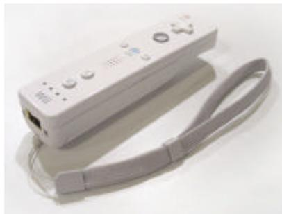
La Wiimote communique normalement avec la Wii grâce à un réseau sans fil Bluetooth. Le périphérique Bluetooth utilisé est basé sur une puce Broadcom 2042, qui est conçue pour fonctionner avec des périphériques suivant la norme Bluetooth Human Interface Device (HID) standard, comme certains claviers ou souris. Le Bluetooth HID est directement basé sur le HID USB standard, et beaucoup de sa documentation s'applique.
